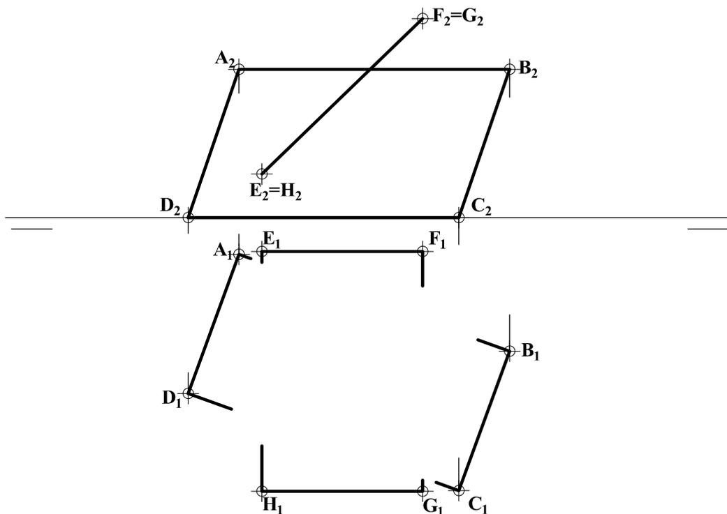
**B3.-** Hallar la figura simétrica del cuadrilátero **ABCD** con respecto al plano bisector que contiene al eje **Z** y al punto **M**.
